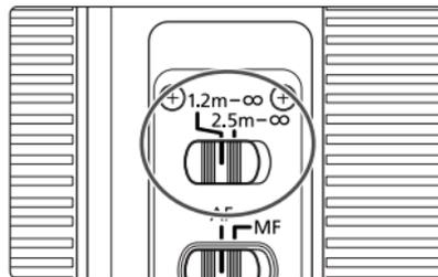
È possibile scegliere tra due gamme di distanze di messa a fuoco: da 1,2 m a infinito e da 2,5 m a infinito.
