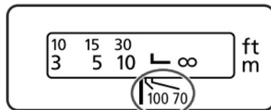
L'indicatore infrarossi corregge la messa a fuoco quando si utilizza una pellicola monocromatica all'infrarosso. Mettere a fuoco manualmente e regolare la distanza, ruotando la ghiera di messa a fuoco fino al corrispondente indicatore di infrarosso.
