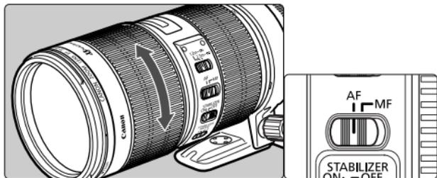
Se si intende scattare foto utilizzando la messa a fuoco automatica (AF), posizionare il selettore della modalità di messa a fuoco su AF. Se si intende utilizzare solo la messa a fuoco manuale (MF), impostare il selettore della modalità di messa a fuoco su MF e mettere a fuoco ruotando l'apposita ghiera. La ghiera di messa a fuoco è sempre operativa, indipendentemente dalla modalità di messa a fuoco utilizzata.
