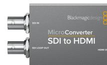
Converte i segnali SDI in HDMI, per trasmettere il video dei dispositivi SDI professionali con le Tv HDMI di largo consumo, i proiettori, e non solo. La connessione 3G-SDI multirate commuta automaticamente tra tutti i formati SD e HD fino al 1080p60. Ospita un'uscita 3G-SDI di loop, è compatibile con con i sistemi di livello A e B, e si alimenta tramite USB.
